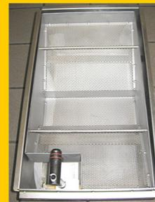
Placer le ramasse-miettes dans le bac en s'assurant qu'il est correctement assis dans le bac.
