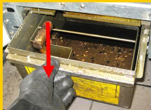
Retirer le bac du filtre et enlever le ramasse-miettes, l'anneau de retenue, le papier-filtre et le tamis intérieur.
