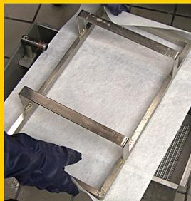
Placer le papier-filtre sur le bac et le presser en place à l'aide de l'anneau de retenue.
